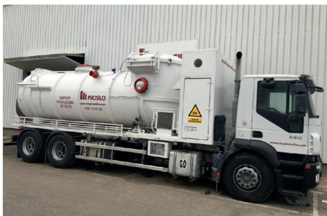
Figura 29. Camión aspirador ATEX con armazón ignífugo.
