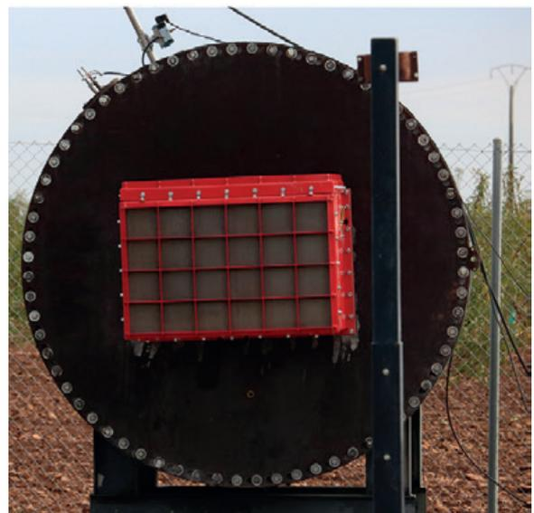
Figura 22. Dispositivo de descarga de la presión de explosión: panel de venteo sin llama.
